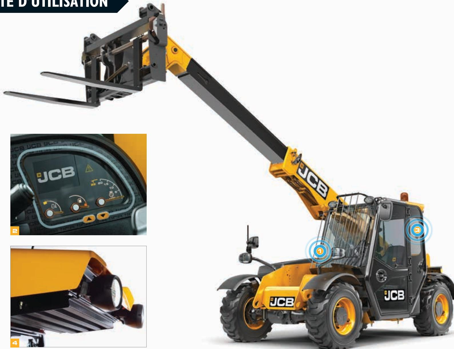
6 La conduite d'un TELESCOPIC JCB 525-60 Hi Viz est agréable, précise et se fait tout en souplesse : il est équipé d'électro-servocommandes à levier unique avec des circuits auxiliaires proportionnels.
